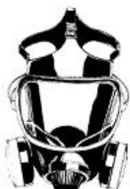
ماسک کامل صورت که می‌تواند با محافظ‌های تصفیه کننده هوا، محافظ‌های برقی تصفیه کننده و محافظ‌های تامین کننده هوا مورد استفاده قرار گیرد.
