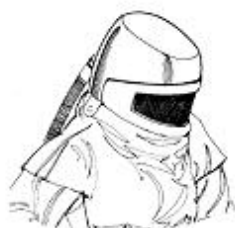
هودها و کلاه‌ها که کارکرد آن‌ها به جریان مستمر حجم زیادی از هوا بستگی دارد. می‌توانند با محافظ‌های تصفیه کننده برقی و سیستم‌های تامین کننده هوا مورد استفاده قرار گیرند
